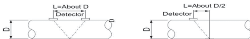
شکل ۴-۳۵. فاصله بین دو سنسور برای سنسور اندازه بزرگ (حد فاصل بین وسط دو سنسور)
