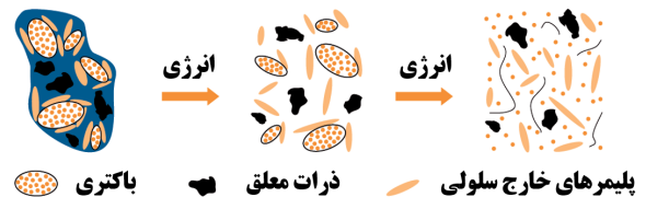
هضم زیست توده ها در تاسیسات تولید بیوگاز
