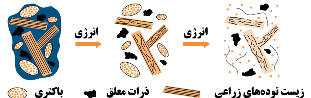
هضم زیست توده ها در تاسیسات تولید بیوگاز
